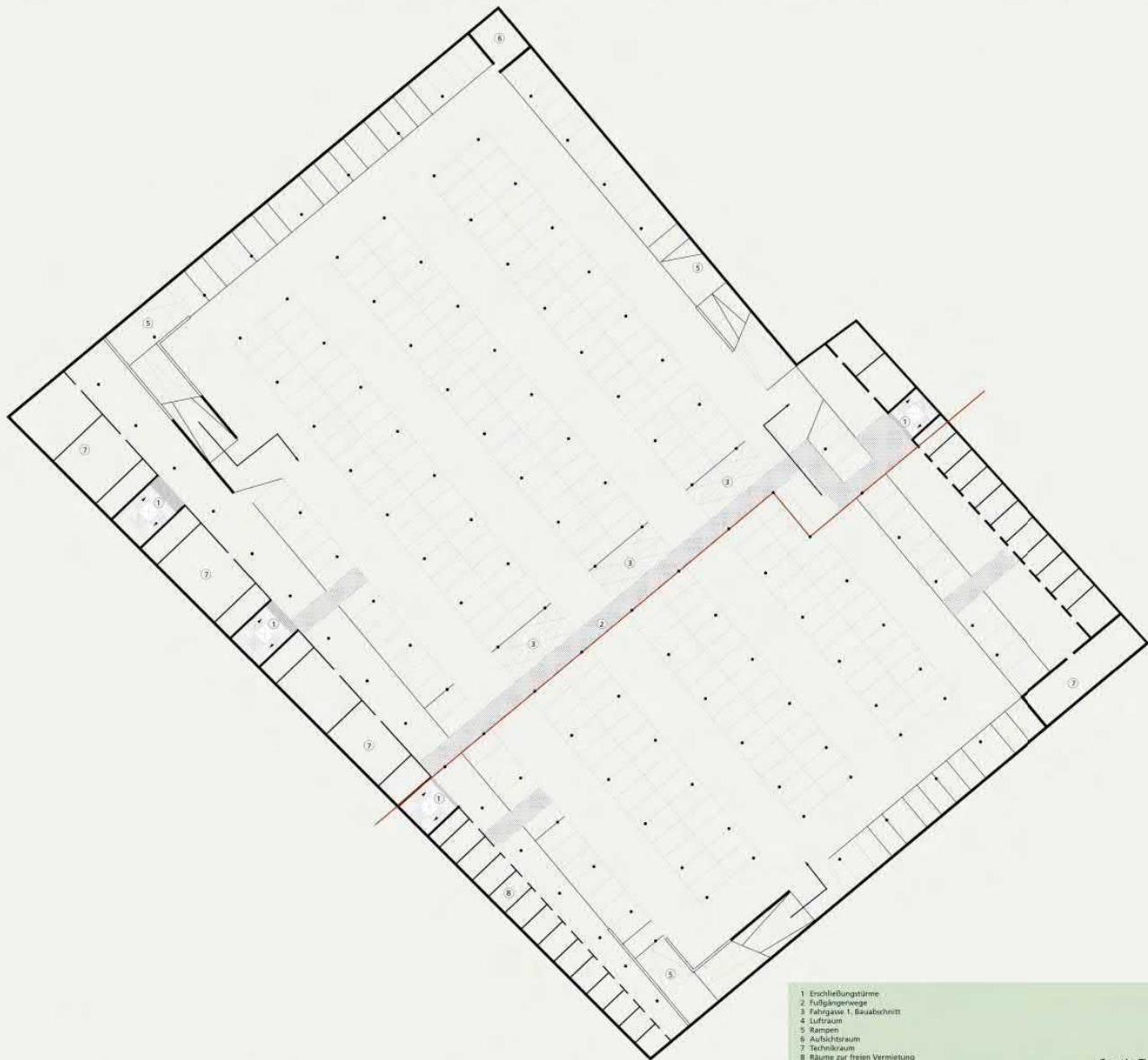
Grundriss Tiefgarage 2. Ebene M 1,200
